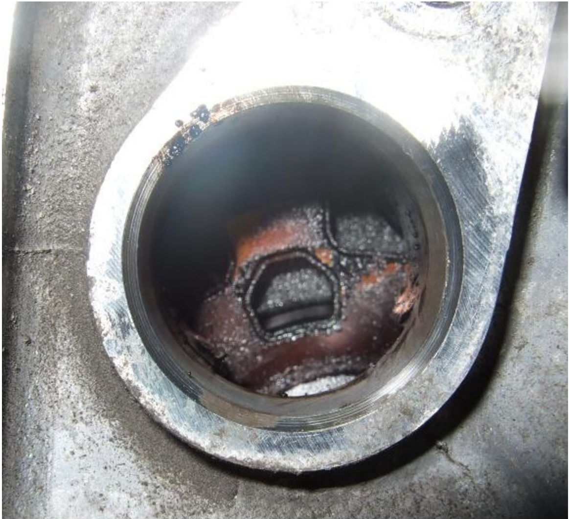
Bild: U-1.0.0_13 – Stellung des Steuernockens eines defekten Steuerkettentrieb
