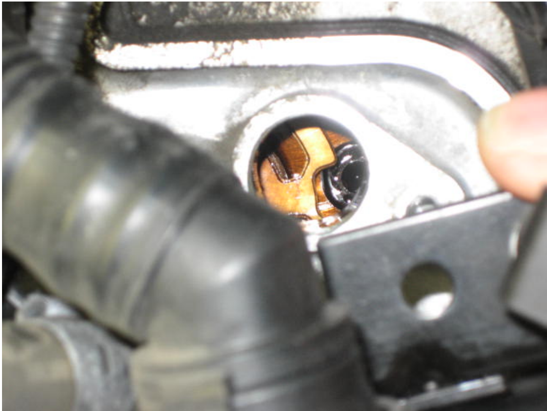
Bild: U-1.0.0_17 – Stellung des Steuernockens eines defekten Steuerkettentrieb
