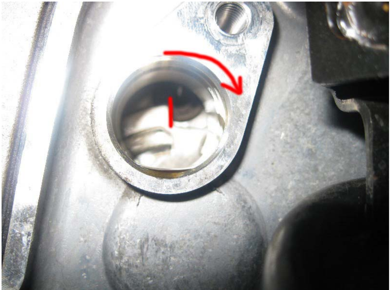
Bild: U-1.0.0_12 – Ideale Stellung eines intakten Steuerkettentrieb
