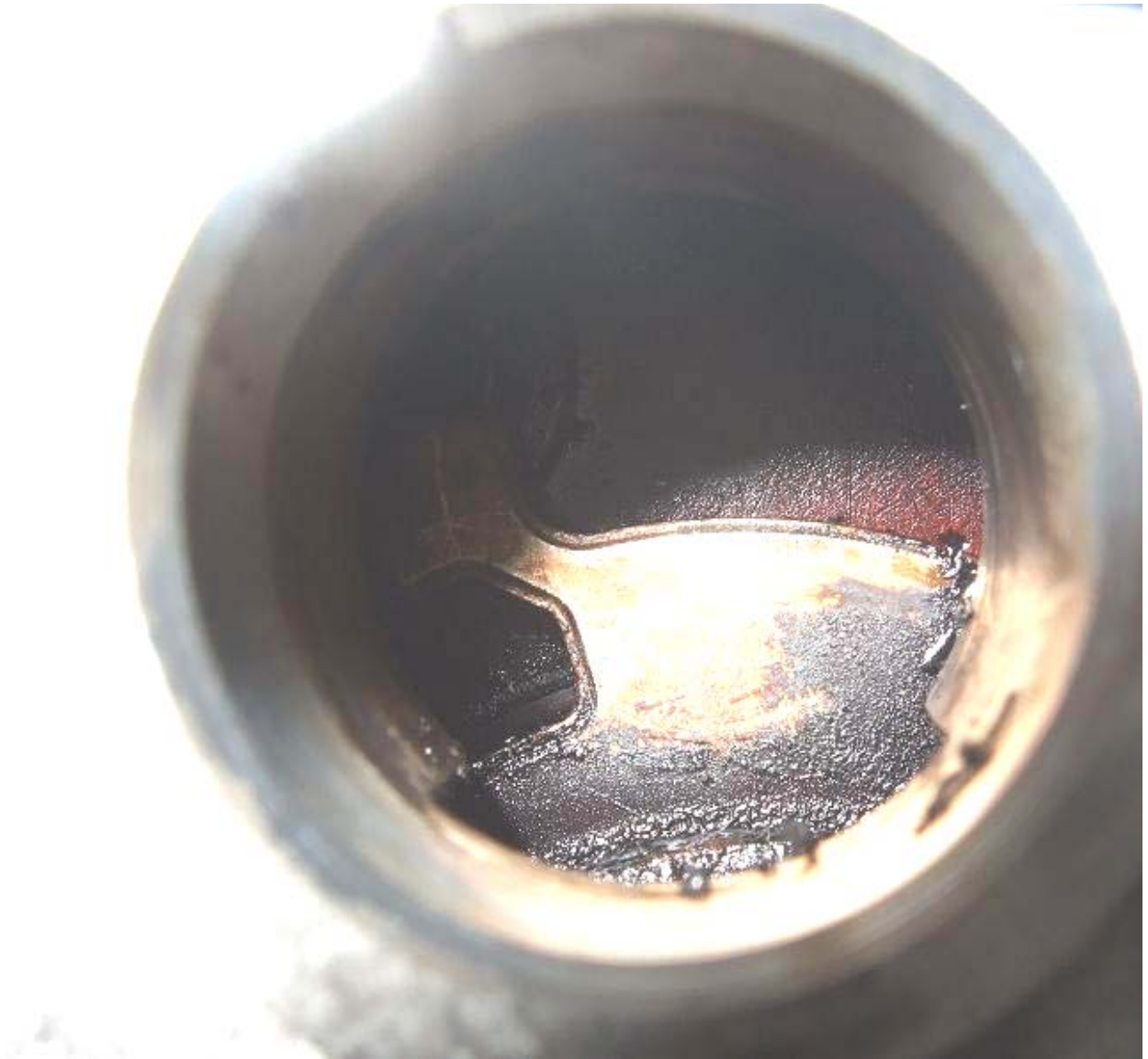
Bild: U-1.0.0_14 – Stellung des Steuernockens eines defekten Steuerkettentrieb
