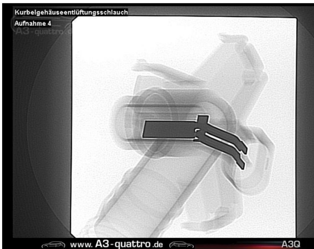
Bild 5.4.1\_9 – Radiografische Aufnahme des Heizelementes
