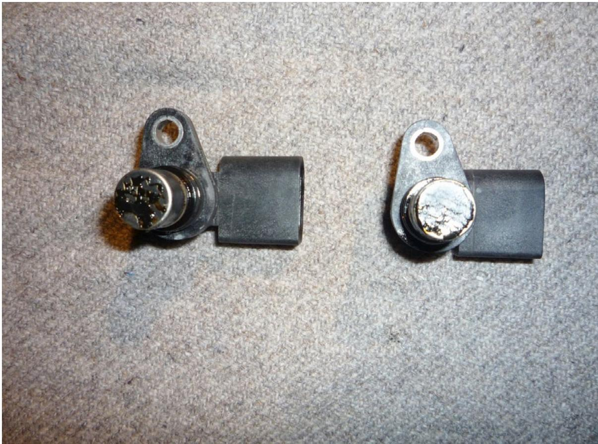
Bild 6.9\_2 – Ausgebaute Nockenwellenpositionsgeber (Hallgeber)
