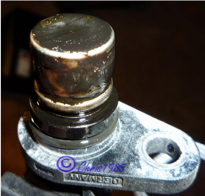
Bild 3.9\_1 – Nockenwellenpositionssensor (Hallgeber) in Großaufnahme
