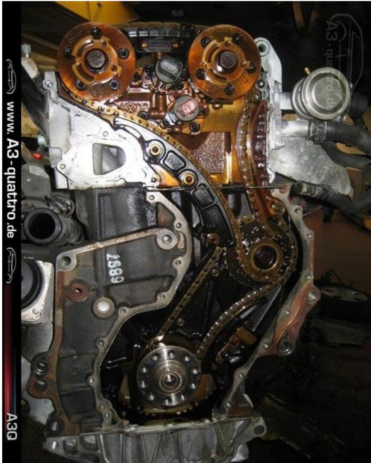
Bild 3.2\_1 - Der Kettentrieb des VR6
