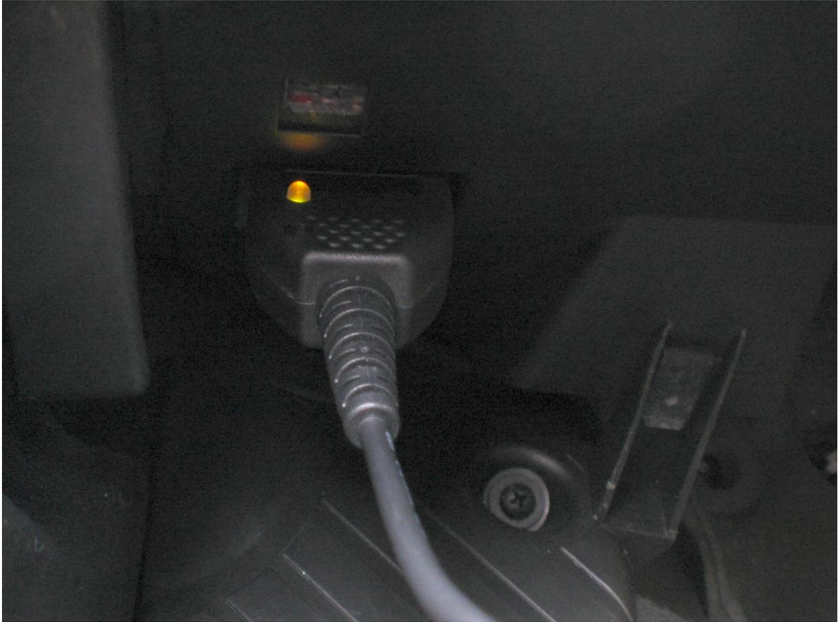
Bild 5.2\_2 – Diagnosegerätstecker in der Anschlussbuchse des Audi A3
