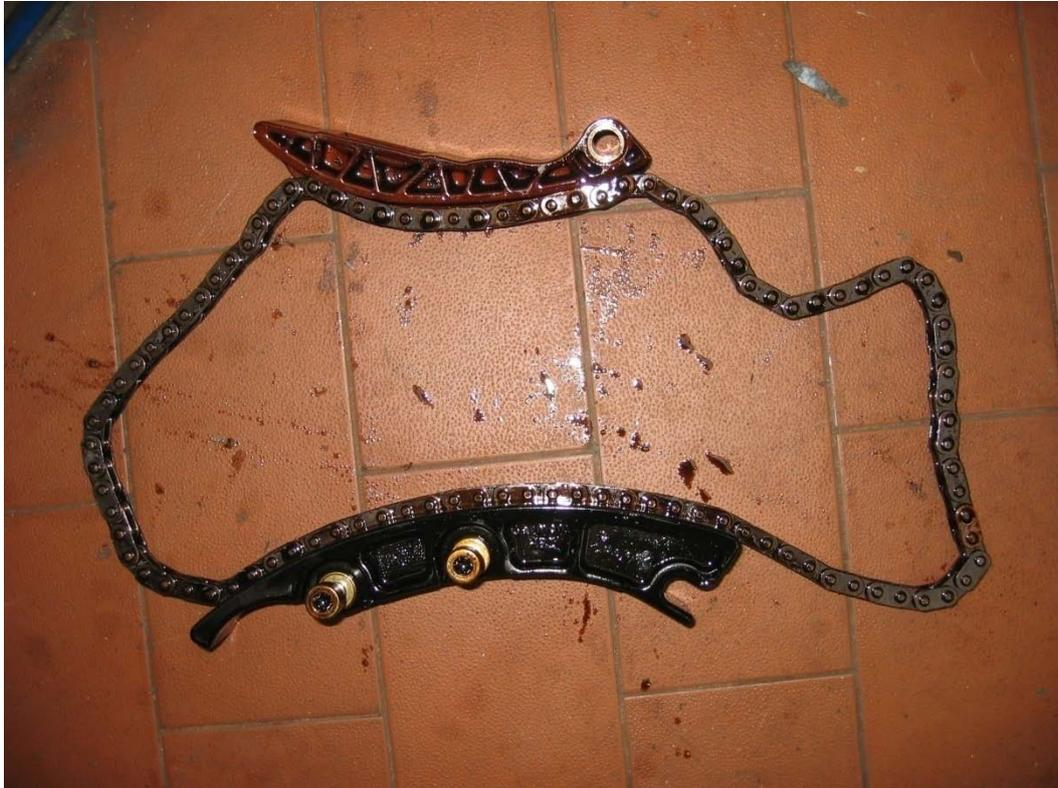
Bild: Anlage 2.5.1\_1 – oberer Kettentrieb mit Laufschiene
