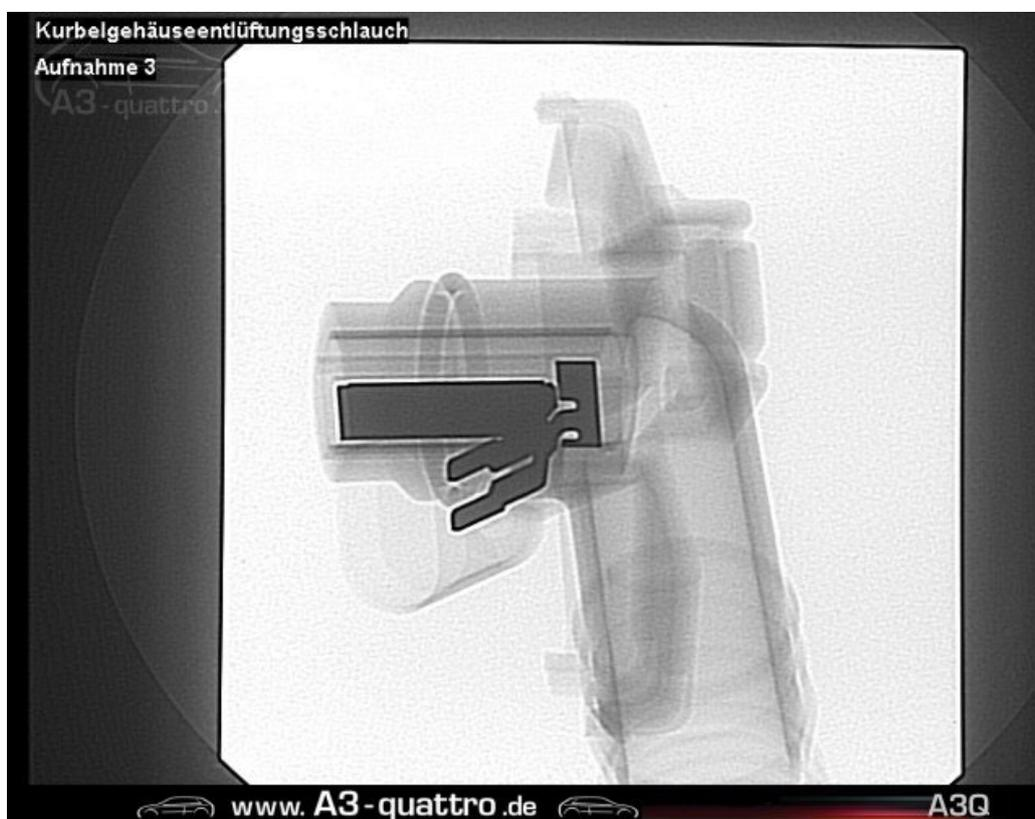
Bild 5.4.1\_8 – Radiografische Aufnahme des Heizelementes
