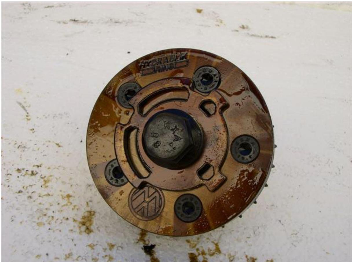
Bild 3.6\_2 Ein Nockenwellenversteller des VR6
