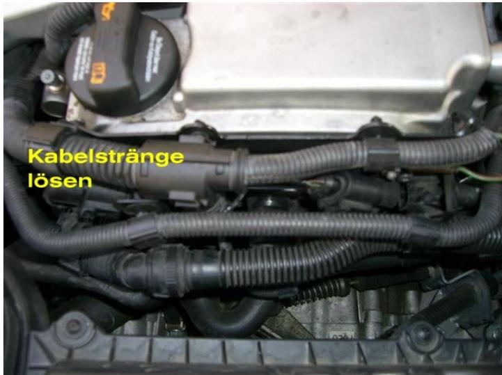
Bild 5.3\_2 – Lösen der Kabelstränge
