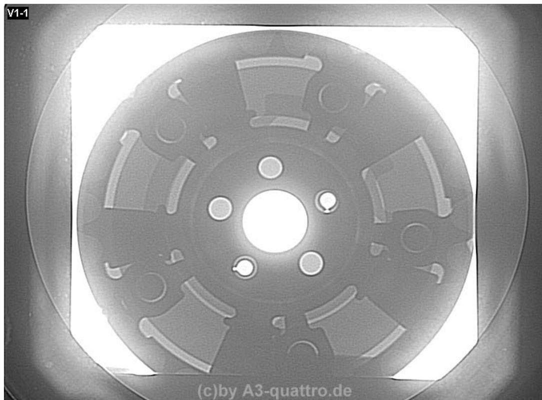
Bild: Anlage 2.6.1\_2 – Nockenwellenversteller
