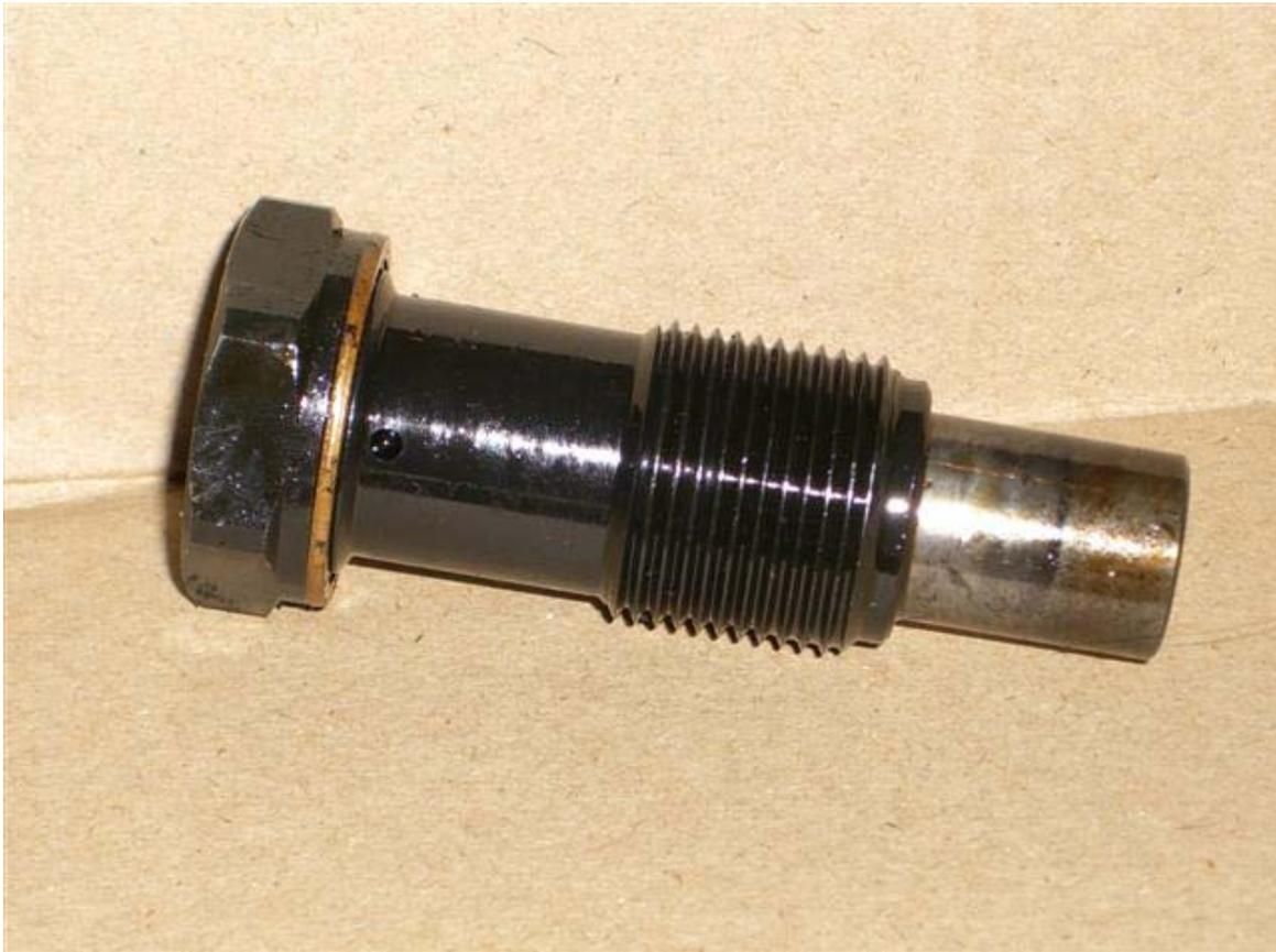
Bild: Anlage 2.4.1\_5 – oberer Kettenspanner
