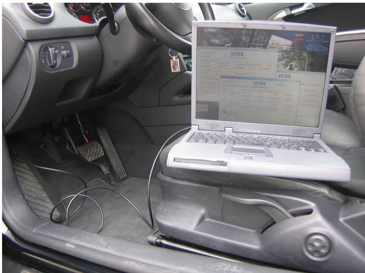
Bild Anlage 4.2.1\_1 – Diagnosegerät am Audi A3
