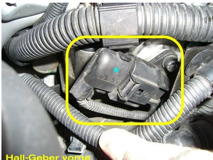
Bild 5.3\_3 – Ausbau der Hallsensoren
