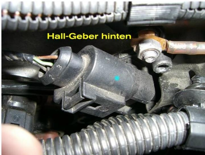
Bild 5.3\_4 – Hallsensor Zylinderbank 2
