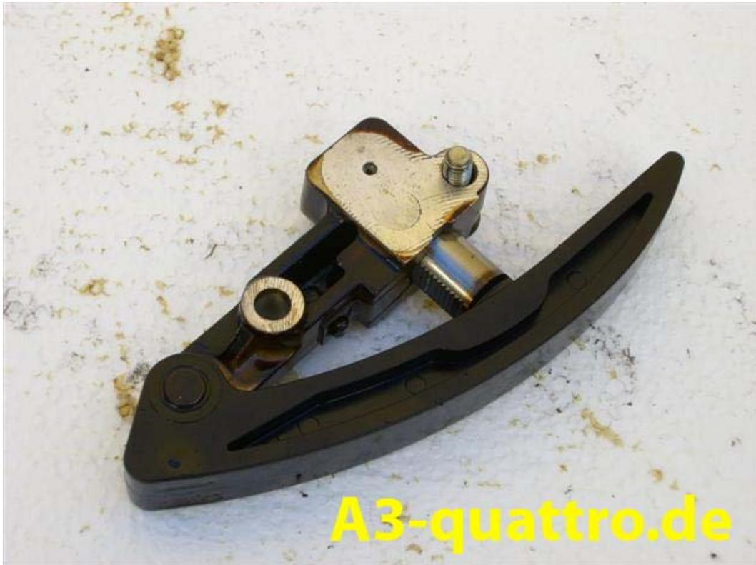
Bild: Anlage 2.4.1\_1 – unterer Kettenspanner
