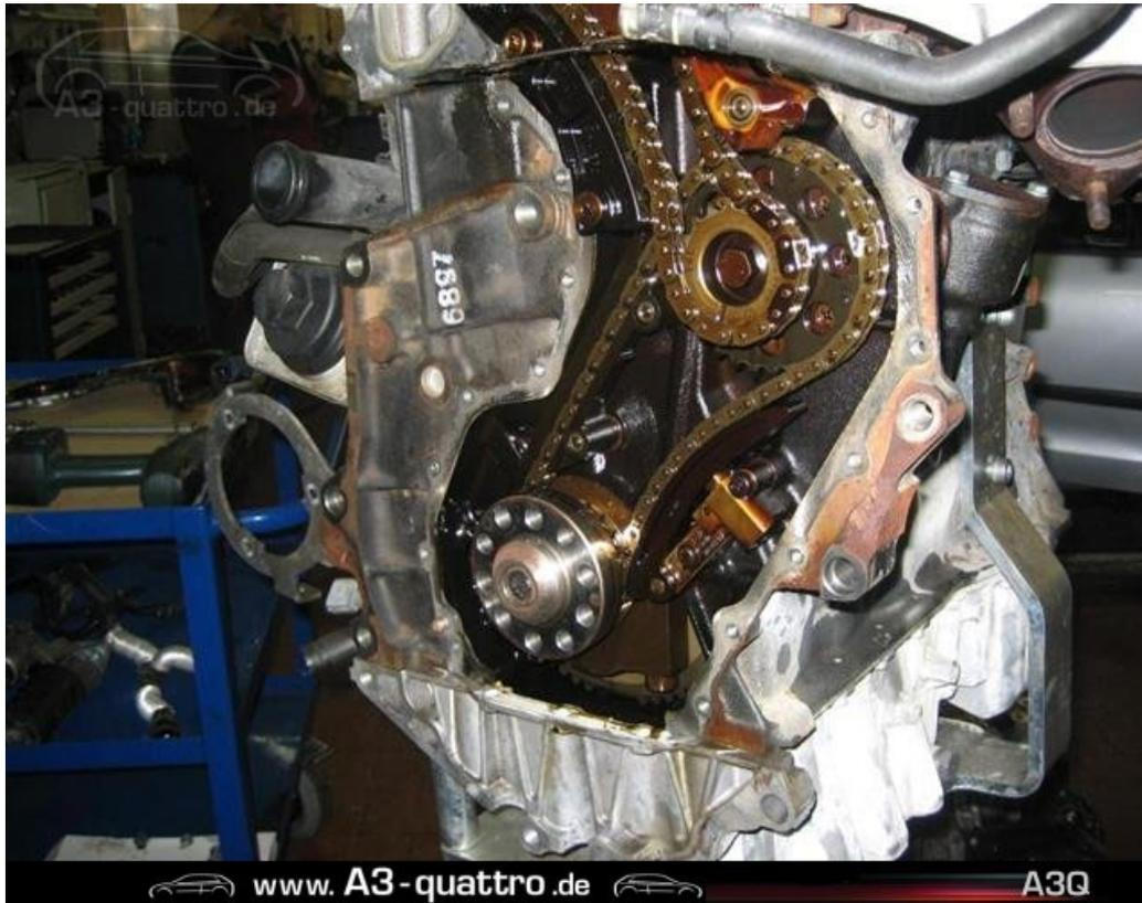
Bild 3.4\_2 - Unterer Kettentrieb des 3.2-Liter VR6 Motor
