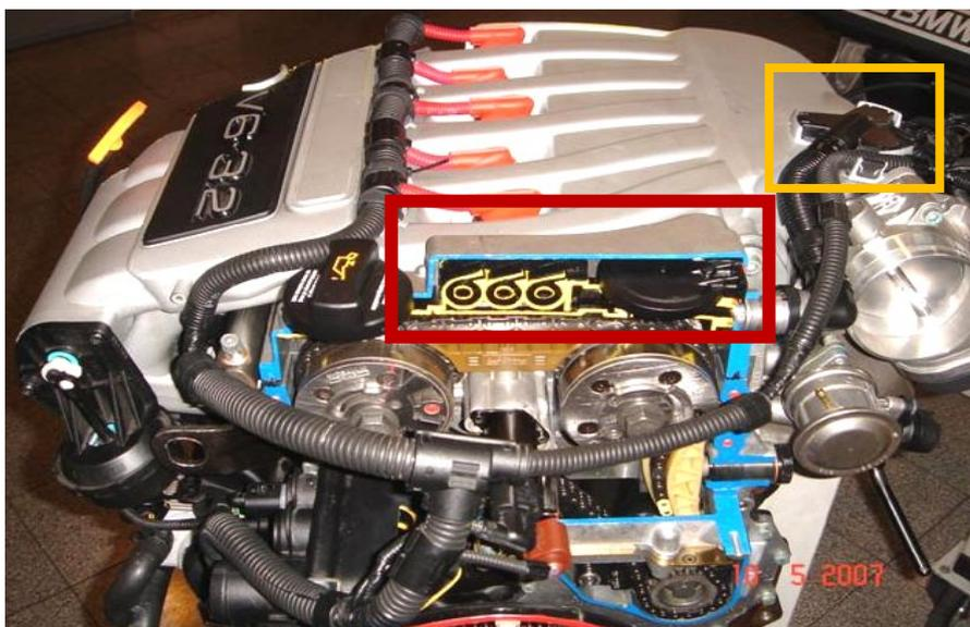
Bild 3.8\_1 –Ölabscheider im Audi A3 3,2l
