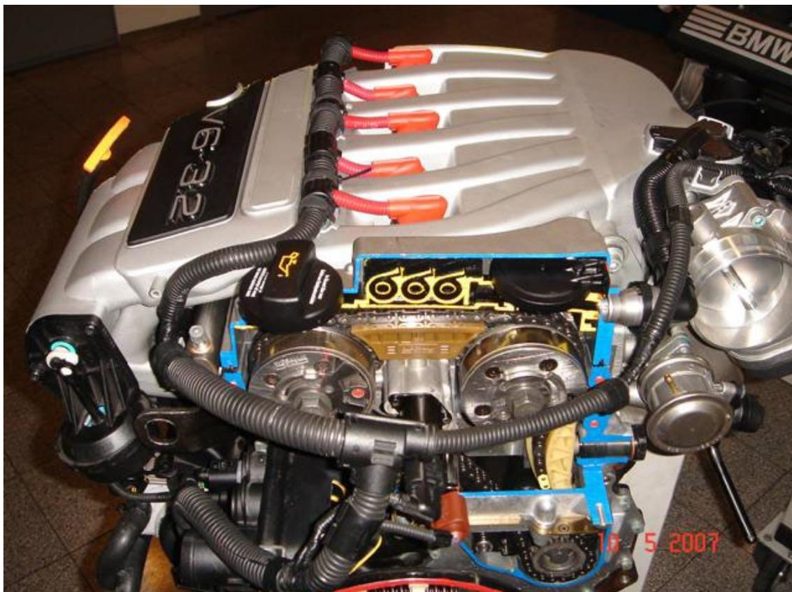
Bild 3.2\_3 - Der Kettentrieb des VR6
