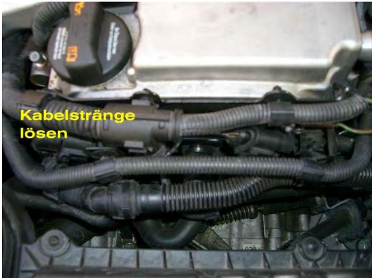
Bild 4.3\_2 – Lösen der Kabelstränge
