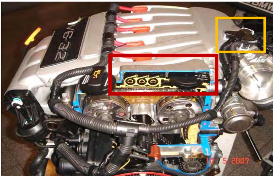
Bild 2.8\_1 –Ölabscheider im Audi A3 3,2l
