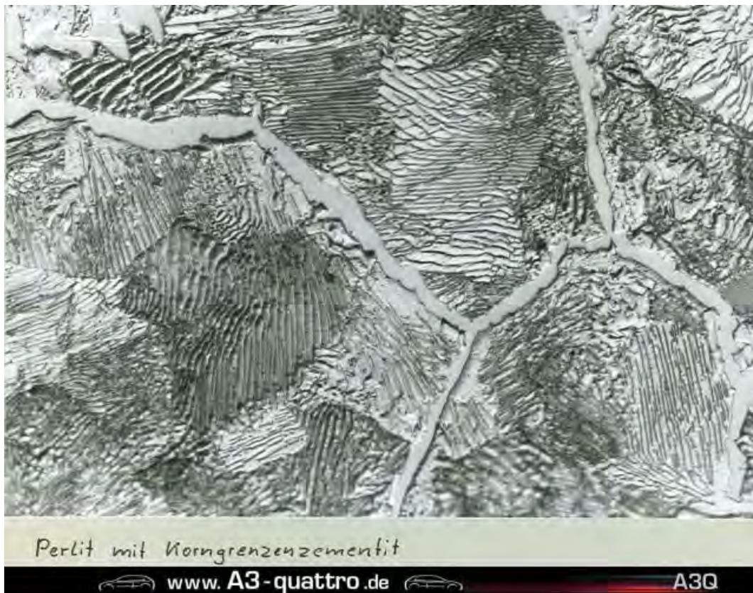
Bild 5.14\_1 - Grundgefüge
