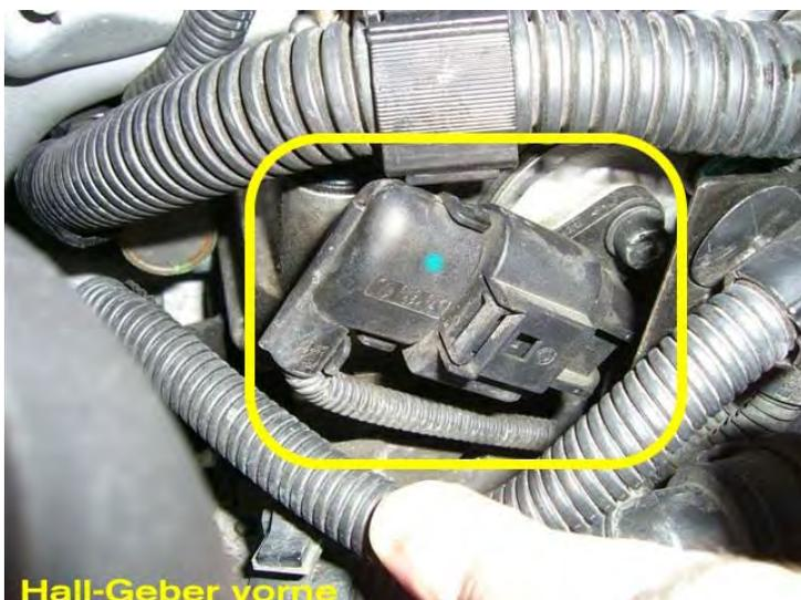
Bild 4.3\_3 – Ausbau der Hallsensoren
