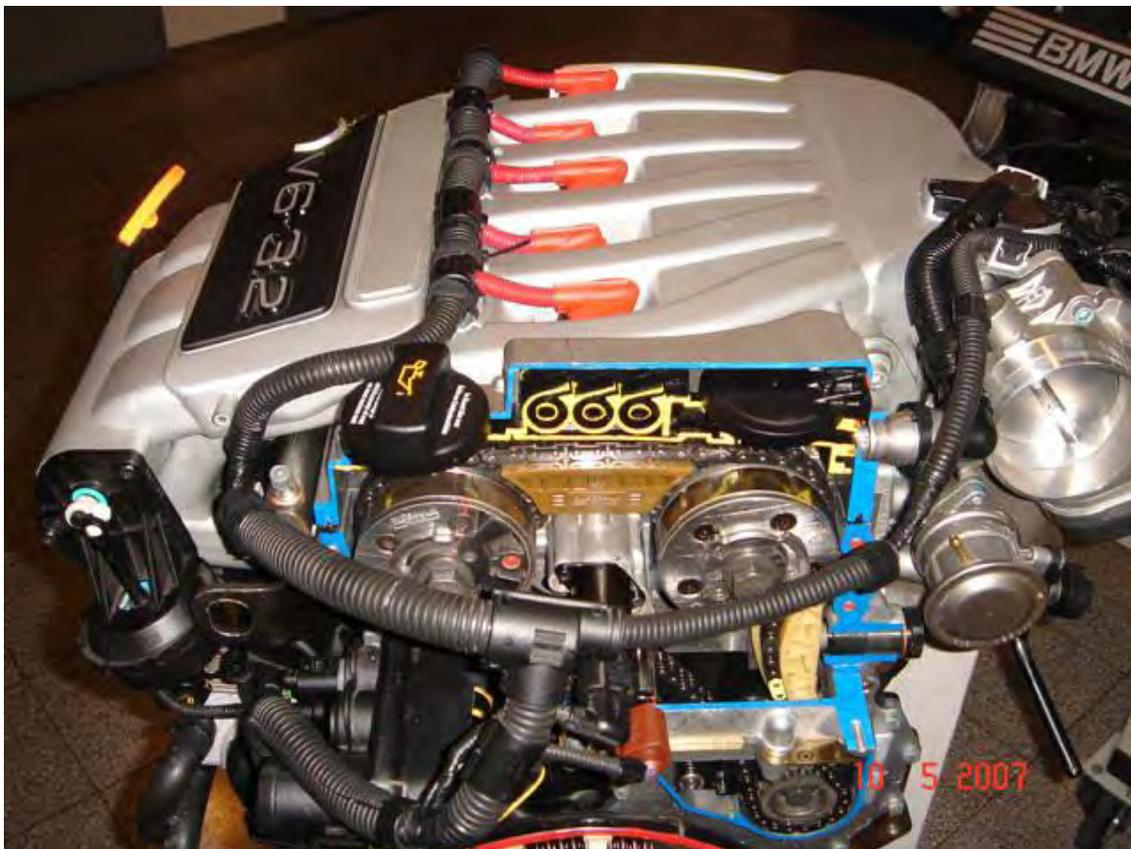
Bild 2.2\_3 - Der Kettentrieb des VR6
