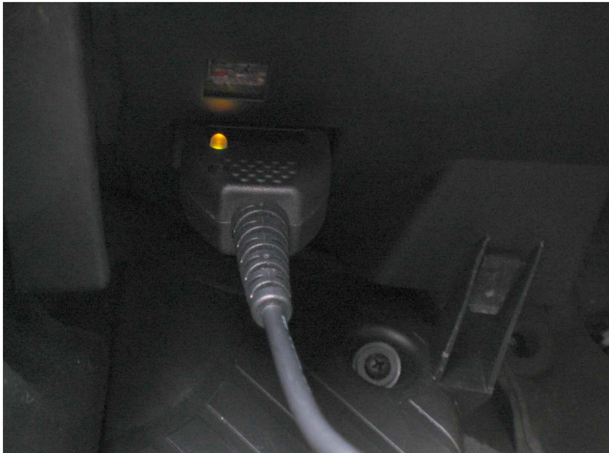
Bild 4.2\_2 – Diagnosegerätstecker in der Anschlussbuchse des Audi A3
