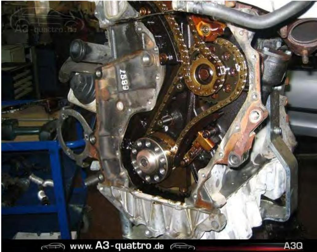
Bild 2.4\_2 - Unterer Kettentrieb des 3.2-Liter VR6 Motor
