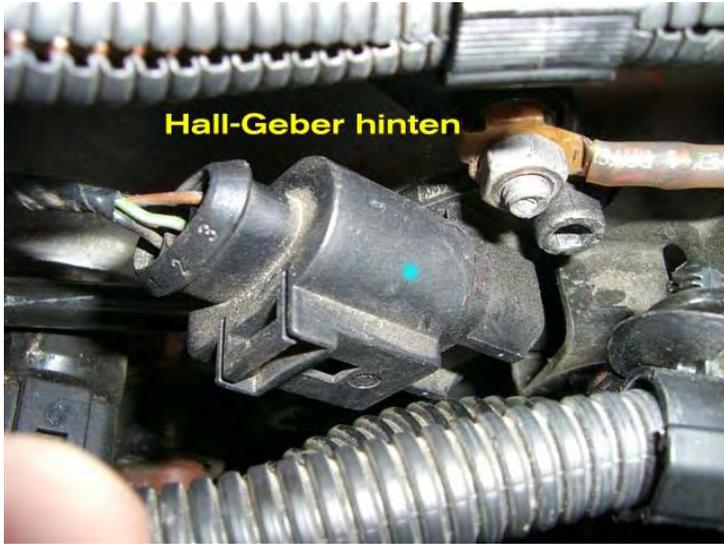
Bild 4.3\_4 – Hallsensor Zylinderbank 2
