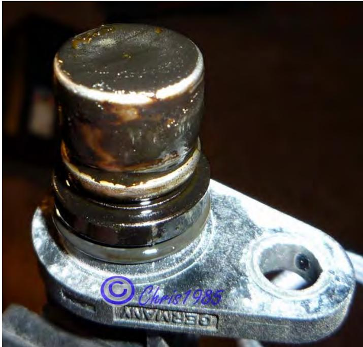
Bild 2.9\_1 – Nockenwellenpositionssensor (Hallgeber) in Großaufnahme
