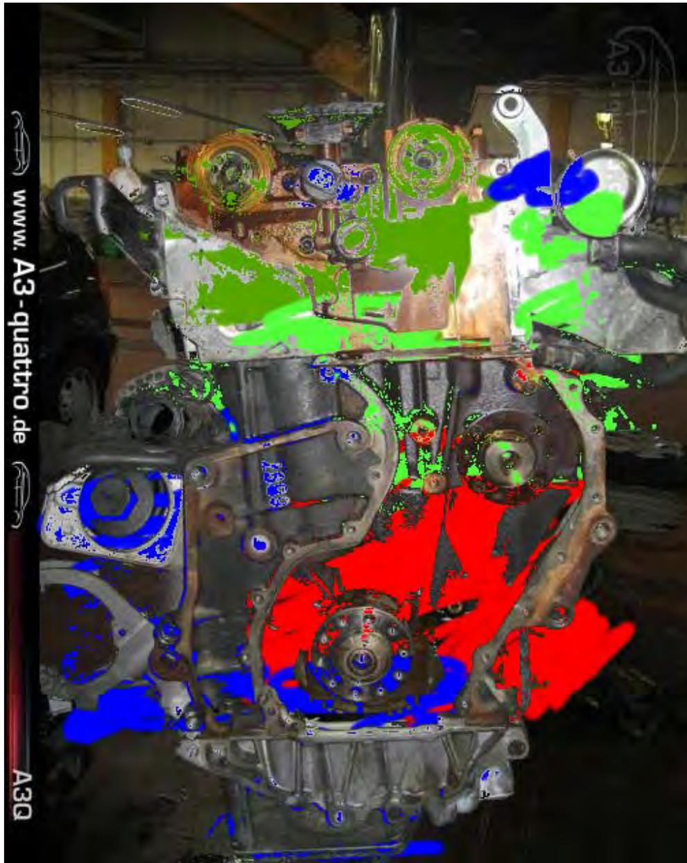
Bild 4.4\_3 – simulierte Schallintensitätsverteilung im Bereich des Kettentriebes
