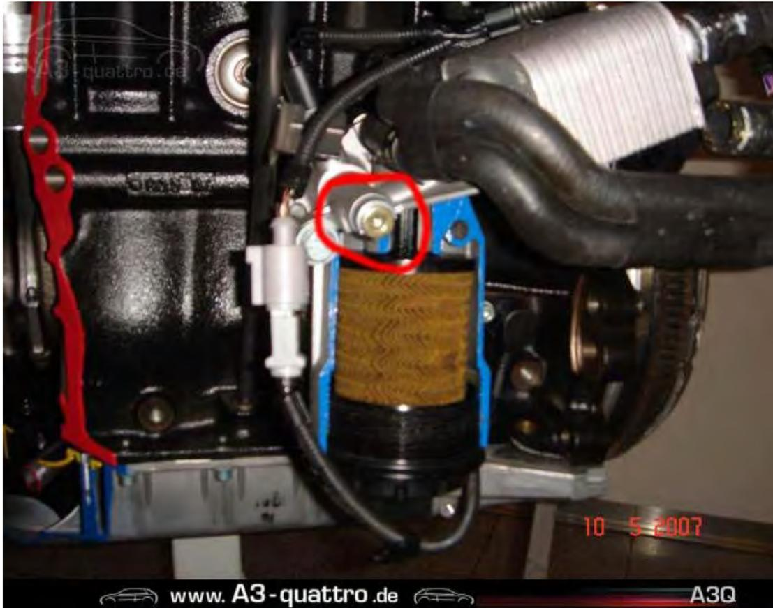
Bild 9\_2 – Lage des alternativen Anschluss
