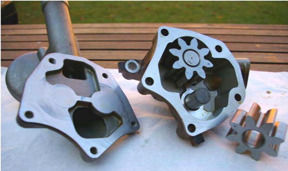
Bild 2.7\_2 – Einzelteile der Ölpumpe aus einem VR6 3,2
