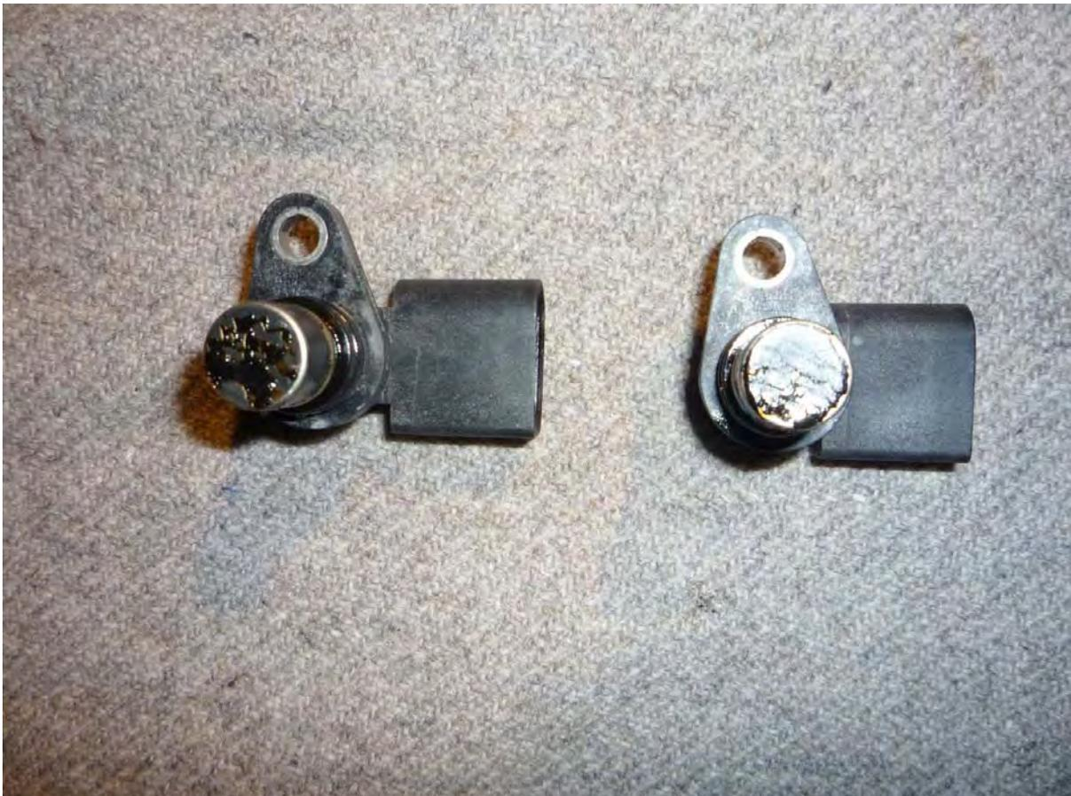
Bild 5.12\_1 – Ausgebaute Nockenwellenpositionsgeber (Hallgeber)
