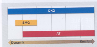
Bild 8: Spannbreite des darstellbaren Fahrverhaltens mit unterschiedlichen Getriebekonzepten
