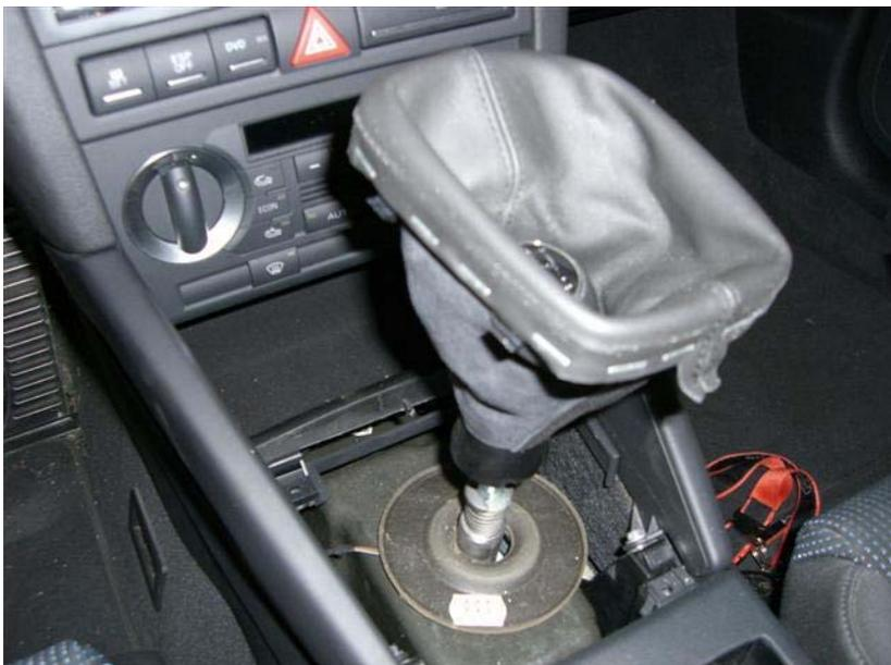
**Ring mit Seitenschneider zerschneiden**
