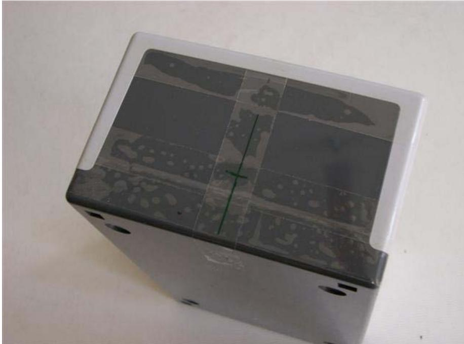
Seitlich wurden 8mm gebohrt, oben mit einem Lochbohrer Durchmesser 50mm ein Loch gebohrt. Die Druckanzeige hat 52mm. Der Rest wurde mit grobem Schmirgelpapier auf Maß geschliffen.
