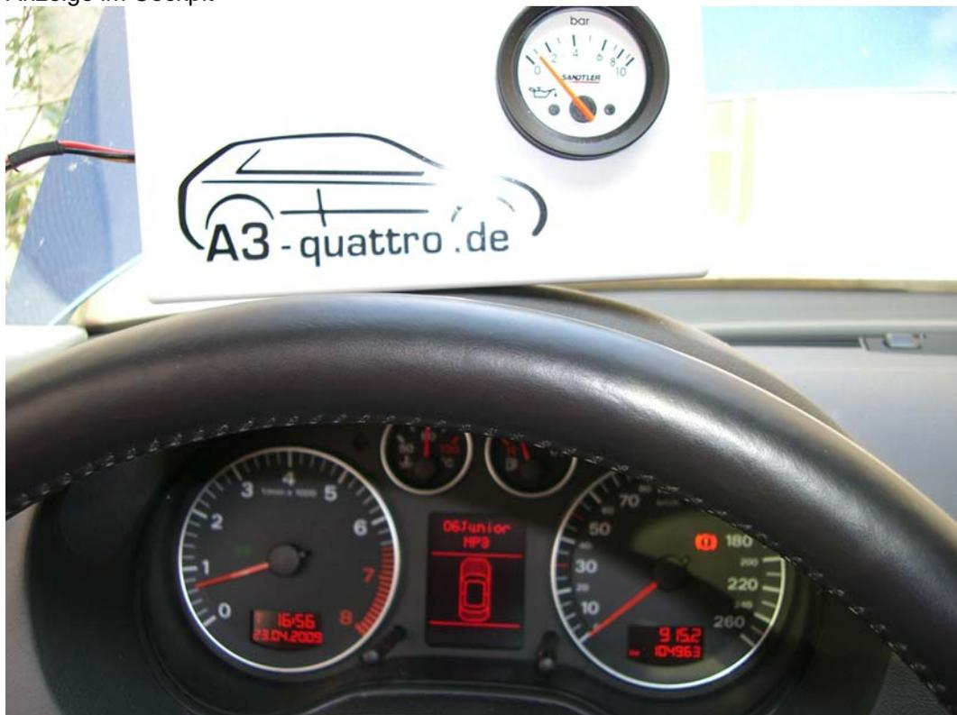
Nun ein Video, erstellt bei betriebswarmem Motor. Ungefähr 2 Bar Druck bei 2000 1/min. sind ein guter Wert. Kritisch sind die Drücke in kaltem Zustand. Hier sollten 6,5 Bar bei 2000 1/min. nicht überschritten werden. Erreicht man Drücke über 7 Bar, so ist die Öldruckpumpe defekt und umgehend zu erneuern, bevor dadurch der Steuerkettentrieb geschädigt wird.
