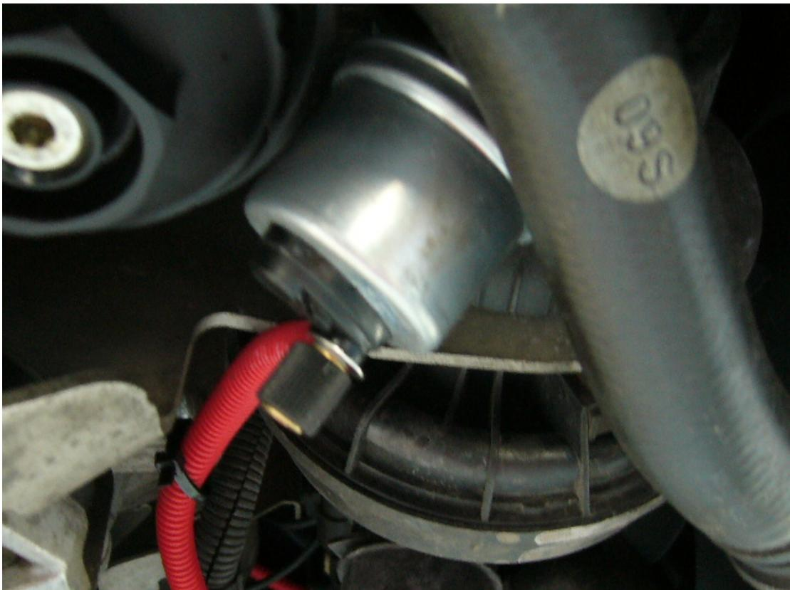
Masseanschluss zum Öldrucksensor am Bremsschlauch
