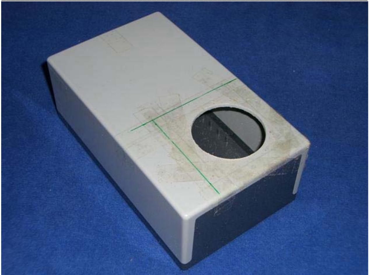
Das Klebeband wurde entfernt und der Kasten mit Äthanol gereinigt. Die 3 Leitungen wurden mit gutem Überstand durch das seitliche Loch geführt, von Innen verknotet und von Außen mit einem Kabelbinder an Gehäusenähe fixiert. Somit erreicht man eine Zugentlastung der Kabel. Von Innen wurde der Kabelknoten zusätzlich mit Gewebeklebeband fixiert.
