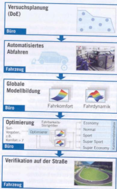
**Bild 2:** Arbeitsablauf bei der modellbasierten Fahrbarkeitsabstimmung
