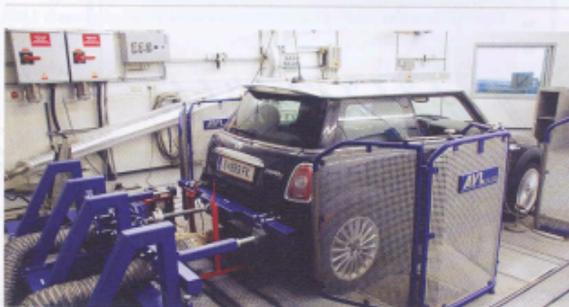
Bild 5: Systemaufbau, Testfahrzeug auf der hochdynamischen Rolle
